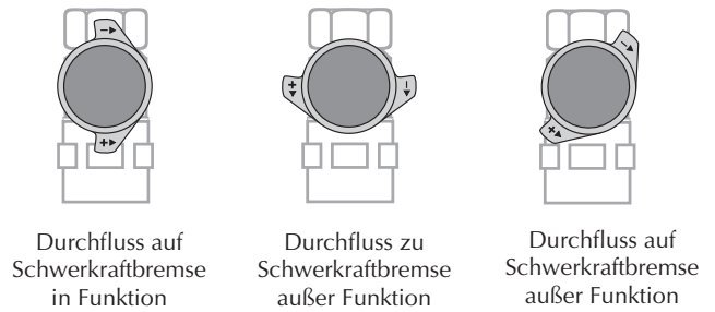
Bild 3 Die drei Funktionen der Kugelhähne in der Solargruppe
