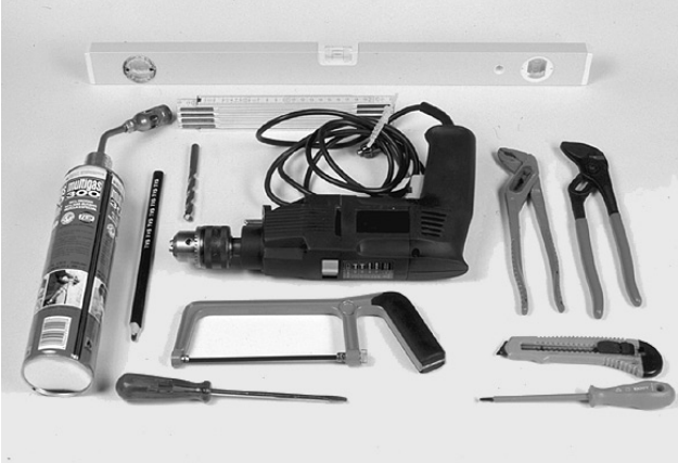
Bild 5 Montagewerkzeug: Bleistift, Zollstock, Wasserwaage, Bohrmaschine, 8/10/12er Steinbohrer, 2 Rohrзangen, Lötбrenner, kl./gr. Schraubendreher, Säge, Messer
