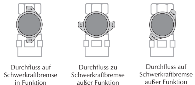
Bild 3 Die drei Funktionen der Kugelhähne mit integrierter Schwerkraftbremse in der Rapido-Solargruppe.
