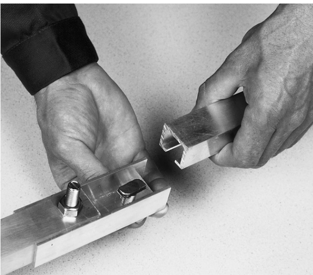
Bild 16 Grundschiene (L 1257 mm) und Erweiterungsschiene (L 1223 mm) mit Kupplungsstück über zwei Hammerkopfschrauben verbinden. Hierbei Schienen bündig aufeinander stoßen.
