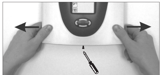
Bild 2 Durch leichtes Ziehen an den seitlichen Laschen des Gehäuseoberteils dieses entriegeln und nach oben klappen bis es einrastet.
