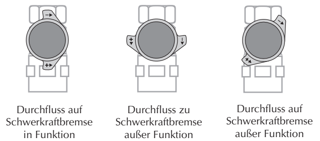
Bild 3 Die drei Funktionen der Kugelhähne in der Solargruppe
