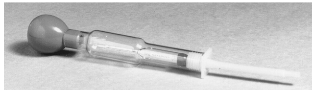
Bild 4 Frostschutzprüfer. Zu prüfende Flüssigkeit muss 20°C haben, sonst stimmt Gefrierpunkt-Angabe nicht!
