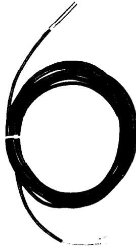
Der Speicherfühler KVT 20 ist ein Tauchfühler mit angeschlossenem Kabel. Er wird in eine entsprechende Tauchhülse im Speicher eingesetzt und erfaßt die Temperatur für die Speicherelektronik. Beim Einsatz des Fühlers in einen Beistellspeicher, kann die Kabellänge des Fühlers entsprechend verlängert werden (max. 20 m – Kabelquerschnitt  $0,75 \text{ mm}^2$ ). Der Widerstandswert beträgt  $2000 \Omega$  bei  $25^\circ\text{C}$  (PTC-Widerstand).
