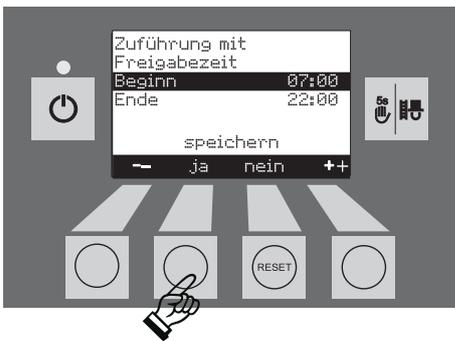
In der Anzeige wird für ein paar Sekunden „Parameterwert wird gespeichert“ angezeigt und danach in die vorhergehende Ebene zurück gewechselt.
