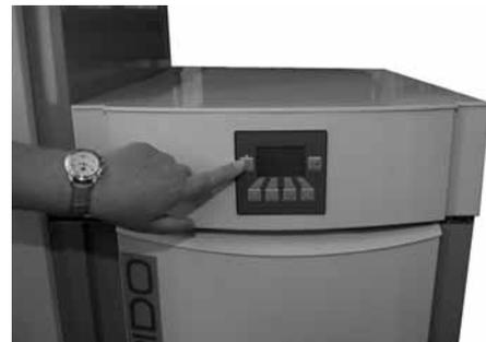
Beim Befüllen entsteht im Pellets-Lager ein Unterdruck, dieser kann beim Pelletskessel einen Rückbrand verursachen, daher darf der Kessel während des Befüllvorganges nicht in Betrieb sein.
