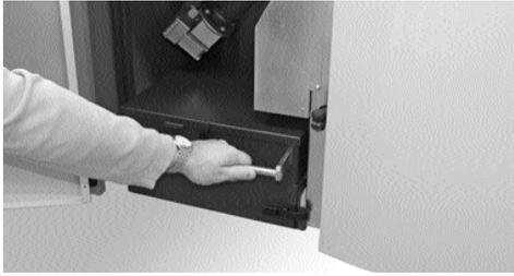
Rechten unteren Spannbügelverschluss lösen.
