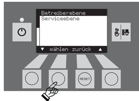
Durch Drücken der zurück-Taste oder nach 45 sec. wird dieser Menüpunkt bzw. Unterpunkt verlassen.
