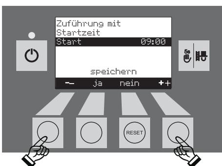
Die geänderte Uhrzeit durch Drücken auf die ja-Taste speichern.
