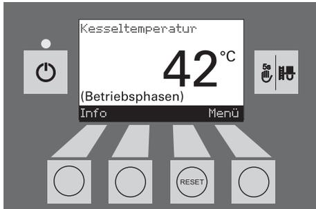
Die Display-Beleuchtung wird automatisch nach 45 sec. ausgeschaltet. Durch Betätigen einer der 6 Tasten wird die Beleuchtung wieder für 45 sec. eingeschaltet.
