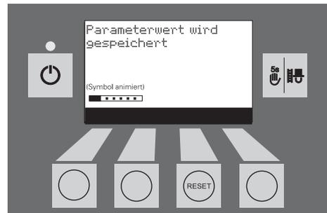
Durch Drücken der zurück-Taste oder nach 45 sec. wird dieser Menüpunkt bzw. Unterpunkt verlassen.
