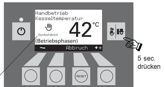
Die verschiedenen Betriebsphasen werden hier angezeigt wie z.B. Brenner in Betrieb, Brenner AUS usw.
