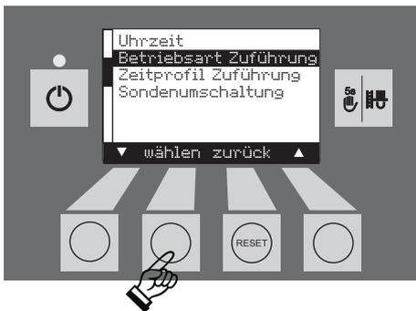
Die **Werkseinstellung** im Menüpunkt „Betriebsart Zuführung“ ist „ausgeschaltet“.
