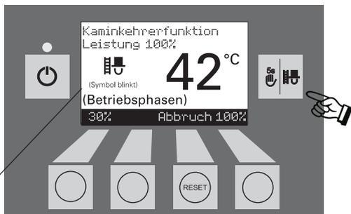
Die verschiedenen Betriebsphasen werden hier angezeigt wie z.B. Brenner in Betrieb, Brenner AUS usw.
