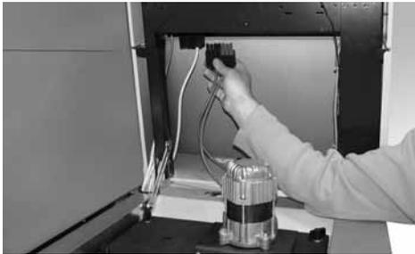
Vier Flügelmuttern vom Gebläsedeckel abschrauben und komplette Gebläseeinheit abheben. Flugasche mit Staubsauger absaugen.
