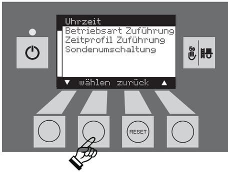
Durch Drücken der zurück-Taste oder nach 45 sec. wird dieser Menüpunkt bzw. Unterpunkt verlassen.
