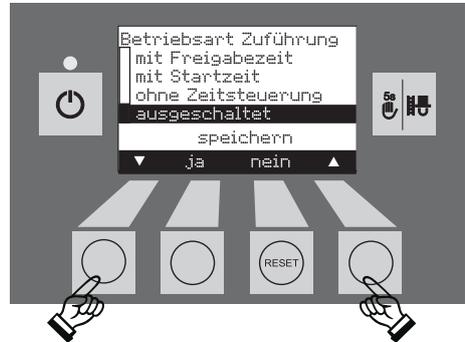
Die geänderte Betriebsart Zuführung wird durch Drücken auf die ja-Taste gespeichert.
