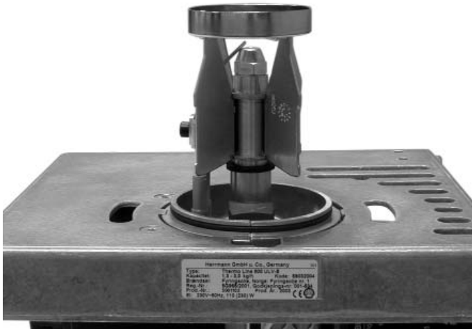
Abbildung 24 - Serviceposition Afb. 24 - Servicepositie Figure 24 - Position de réparation
