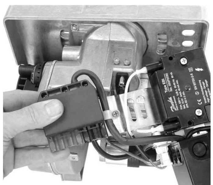
Abbildung 29 - Steuereinheit abgenommen Afb. 29 - De stuur eenheid is verwijderd Figure 29 - Organe de commande retiré
