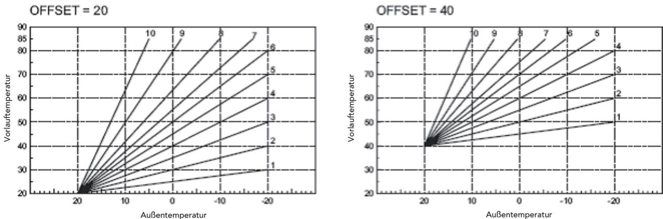
Abb. 14 - Beispiel für die Parallelverschiebung der Heizkurven
