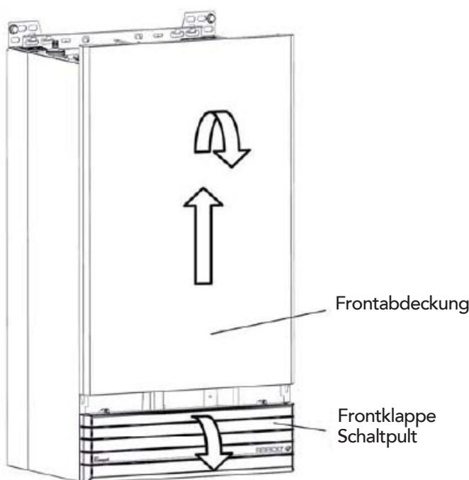
Abb. 34 - Öffnen der Verkleidung
