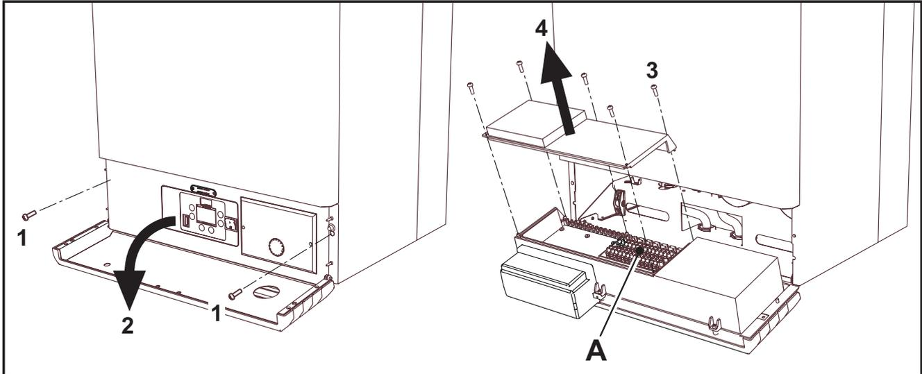
Abb. 21 - Zugang zur Klemmleiste
