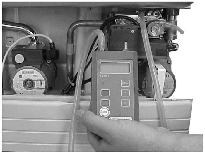
Abb. 5.12 Gasdruckmessung
