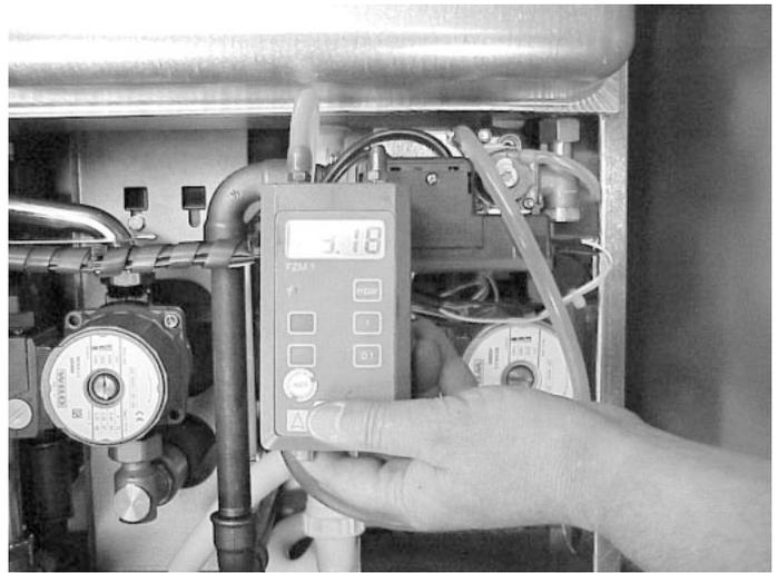
Abb. 5.6 Gasdruckmessung
