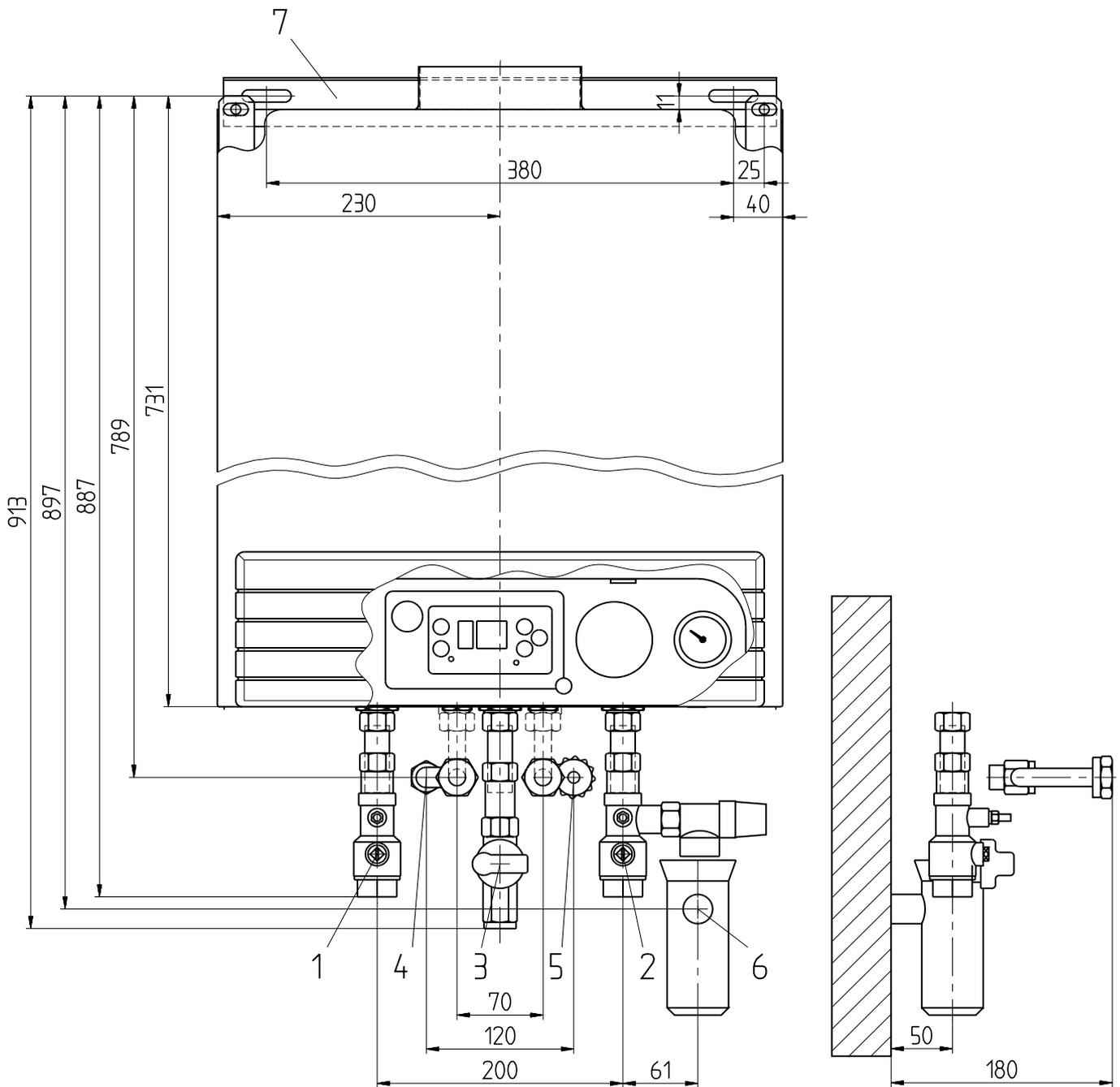
Abb. 3 Aufputzinstallation Econtherm C / Econtherm CT
